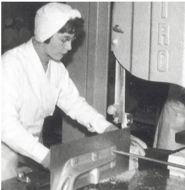
Þegar búið var að taka utan af blokkinni fór hún í bandsagir þar sem hún var söguð niður í lengjur.
